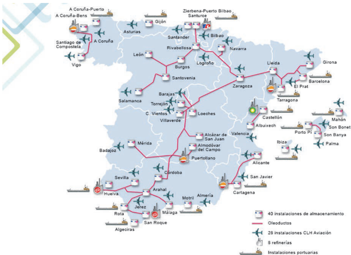
FIGURA 11.5. INFRAESTRUCTURAS PARA EL TRANSPORTE Y ALMACENAMIENTO DE PRODUCTOS PETROLÍFEROS
